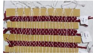
Gambar 1. Uji Coba 1 Kepang dan Pilin dengan variasi kepanan bulat 4 helai, ukuran 3 mm; kepanan 3 helai, ukuran 3 mm; pilin 3 helai, ukuran 3 mm.
