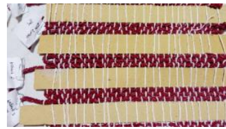
Gambar 2. Uji Coba 1 Kepang dan Pilin dengan variasi pilin 2 helai, ukuran 3 mm; kepanan bulat 4 helai, ukuran 2 mm; kepanan 3 helai, ukuran 2 mm.
